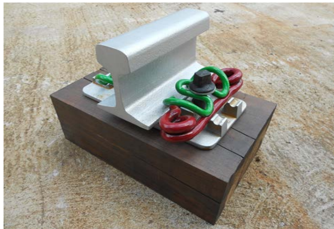
Рис.3 Экспериментальный образец подкладочного рельсового крепления типа СРД-49.
